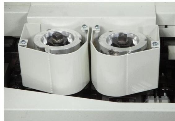
**Rettifica variabile 0,4-3mm** con la guida in entrata facilmente regolabile con pomolo ed indicatore di posizione.
