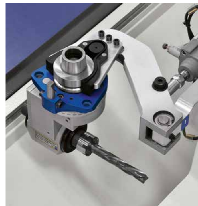
Magazzino "Pick-up" a 1 posizione ancorato alla traversa mobile. Allestimento ideale per l'utilizzo di utensili e testine a rinvio angolare ingombranti.
