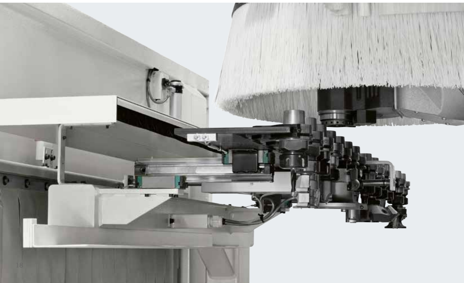
Magazzino "Pick-up" a 1 posizione ancorato alla traversa mobile. Allestimento ideale per l'utilizzo di utensili e testine a rinvio angolare ingombranti.
