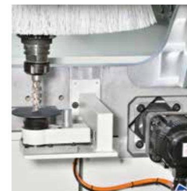
SENSORE LUNGHEZZA UTENSILE Posto a lato del basamento, consente di misurare automaticamente la lunghezza dell'utensile.
