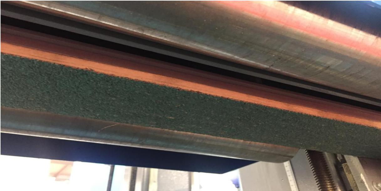
È possibile variare il grado di rusticatura impostando la profondità di lavorazione e la frequenza dei segni aumentando la velocità di rotazione o diminuendo la velocità d'avanzamento. Sostituendo la tipologia delle spazzole si possono ottenere diversi gradi di finitura.
