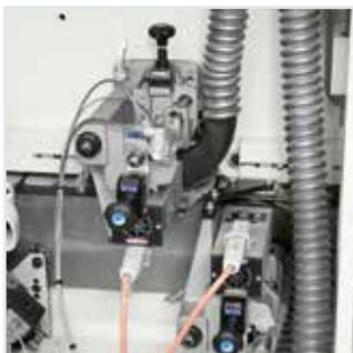
**Gruppo refilatore R-K:** Rapido cambio di lavorazione automatico tra bordo sottile, di spessore e massello.
