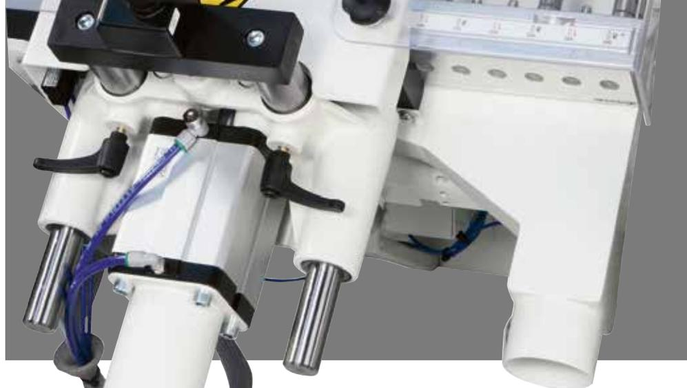
La macchina è dotata di un revolver meccanico con 5 profondità di foratura.
