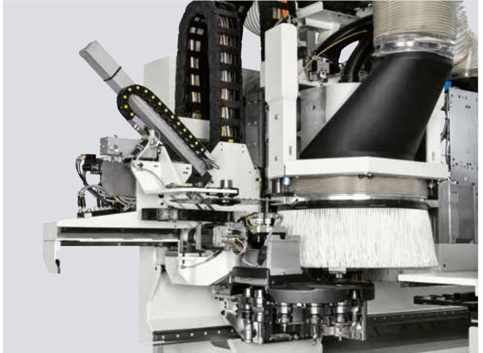
Il magazzino cambio utensile on-board "VELOCE" da 12 o 16 posizioni, posizionato a fianco dell'elettromandrino, permette la sostituzione degli utensili in tempo mascherato. Disponibile anche con **pick-up lama**, in aggiunta agli altri utensili.
