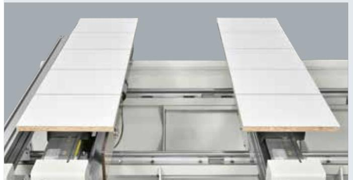
*Da un solo pannello si possono ricavare più elementi e riposizionarli in automatico per eseguire tutte le lavorazioni necessarie senza interrompere mai il ciclo produttivo; al termine i pezzi vengono riportati nella posizione iniziale per facilitare lo scarico dal piano di lavoro.*
