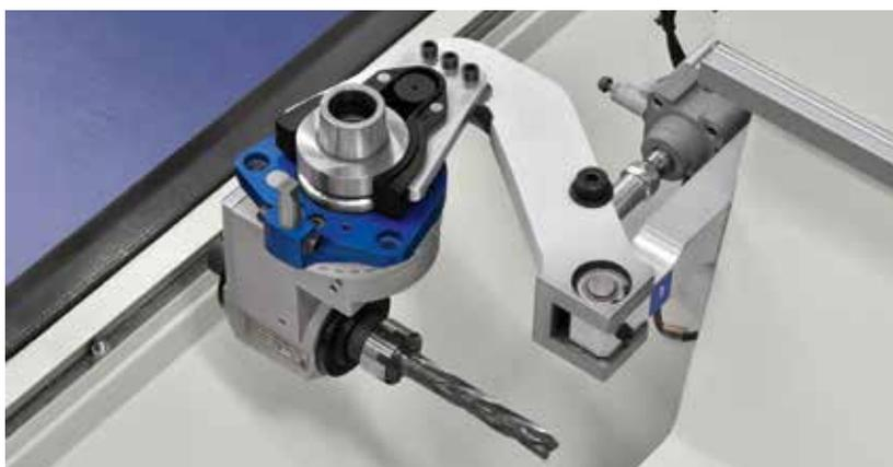
Magazzino "Pick-up" a 1 posizione con posizionamento pneumatico ancorato alla traversa mobile. Allestimento ideale per l'utilizzo di testine a rinvio angolare ingombranti.
