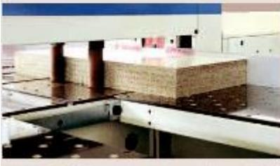
L'allineatore laterale con due elementi di pressione ottimizza la sua corsa in base alla larghezza dei pannelli.
