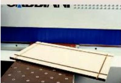
L'esecuzione di cave è automatica ed è gestita elettronicamente in base alle dimensioni impostate sul PC di bordo macchina.
