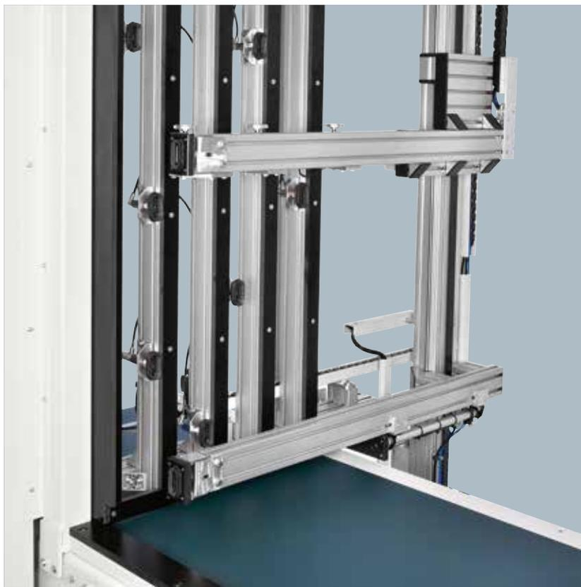
Sistema di posizionamento dei moduli di sostegno del mobile sul preassemblatore **action ws**: il dispositivo, tramite motori brushless e guide lineari, **permette di ridurre il tempo ciclo necessario**.
