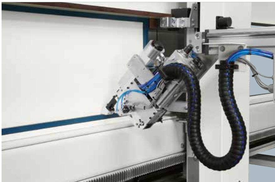
**Graffatore automatico a 5 assi** per schiene di mobili, installabile sullo strettoio **action tf**. Ideale per i produttori di cucine, camere e mobili da bagno.
