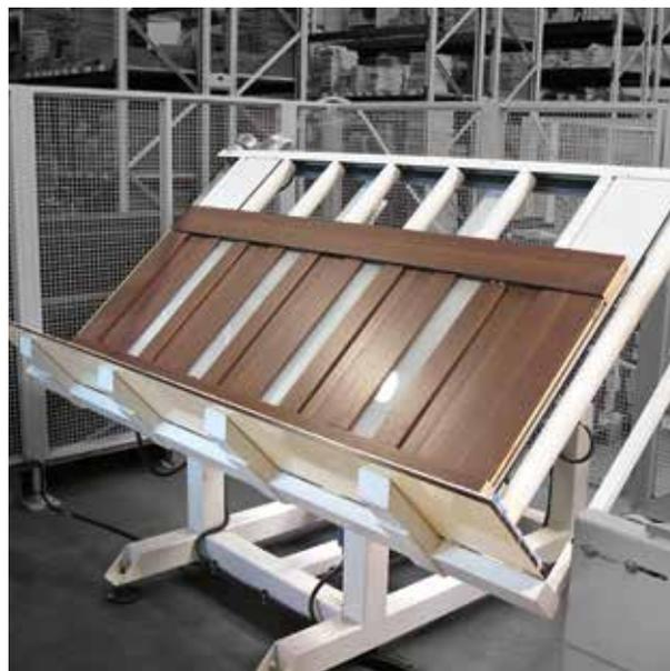
Linea di porte da interno con strettoio *action h*
